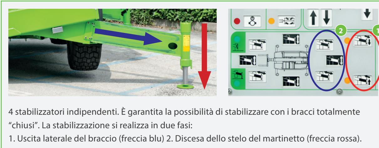
4 stabilizzatori indipendenti. È garantita la possibilità di stabilizzare con i bracci totalmente "chiusi". La stabilizzazione si realizza in due fasi:
