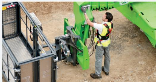
Tubazioni, cavi elettrici e prese idrauliche ausiliarie sono collocati all'interno del braccio in modo da garantire la massima protezione.
