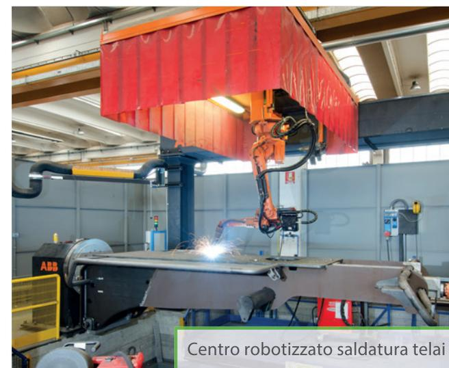
Centro robotizzato saldatura telai
