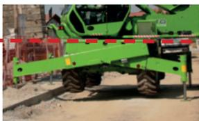
L'**auto-livellamento** si attua in automatico al termine dell'**auto-stabilizzazione**, garantendo l'orizzontalità del telaio in modo da ottenere la massima sicurezza operativa.
