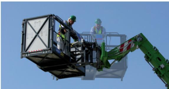
La rotazione idraulica attorno all'asse verticale di molte piattaforme aeree Merlo consente il lavoro con macchina angolata
