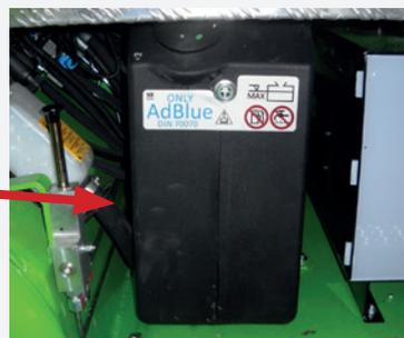
Il serbatoio dell'Urea (A) è di 25 litri sufficienti per due pieni di gasolio. Una spia sul pannello strumenti segnala la necessità di rifornimento.
