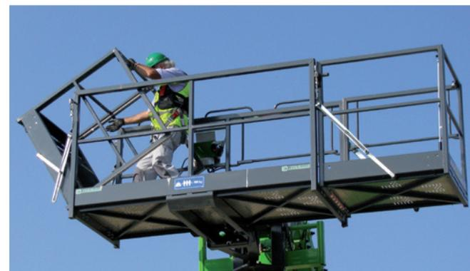
In alcune piattaforme aeree Merlo la larghezza utile è variabile grazie al pratico sistema di estensione brevettato, operabile anche in quota
