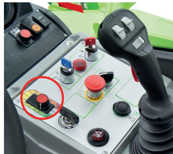
Potenzimetro per l'impostazione manuale dei giri motore diesel
