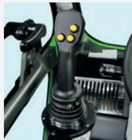
Il secondo bracciolo con joystick (in opzione) consente di eseguire le operazioni di sfilo del braccio, inclinazione zattera e azionamento attrezzature.
