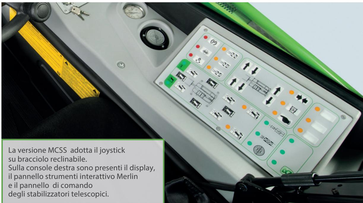
La versione MCSS adotta il joystick su bracciolo reclinabile. Sulla console destra sono presenti il display, il pannello strumenti interattivo Merlin e il pannello di comando degli stabilizzatori telescopici.
