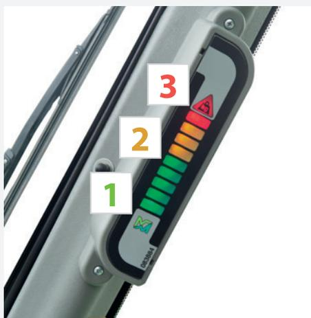
La condizione di stabilità della macchina viene visualizzata costantemente sul segnalatore (25) luminoso in cabina, dotato di 3 settori d'informazione:
