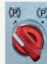
Selettore del freno di stazionamento manuale il cui inserimento automatico avviene allo spegnimento del motore.
