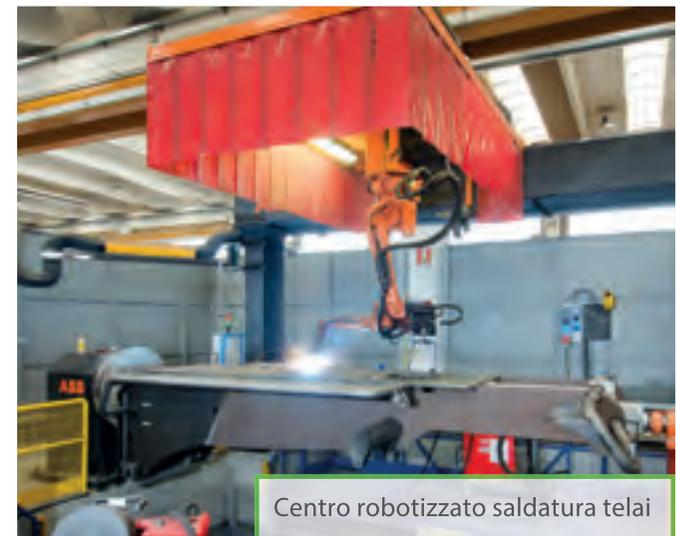
Centro robotizzato saldatura telai
