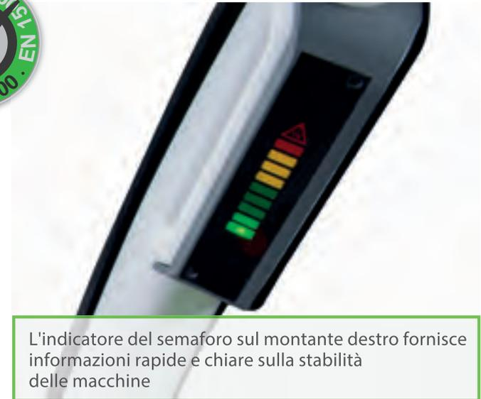
L'indicatore del semaforo sul montante destro fornisce informazioni rapide e chiare sulla stabilità delle macchine
