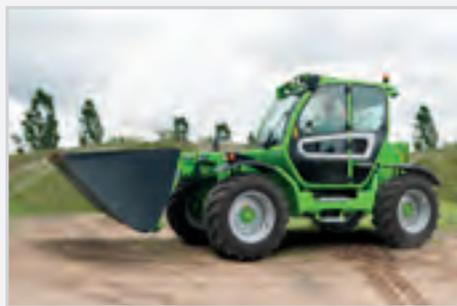
**BSS:** Sospensione idropneumatica del braccio (opzionale). Può essere attivata dall'operatore e si disattiva automaticamente sotto i 3 km/h per garantire massima precisione nel posizionamento dei carichi.
