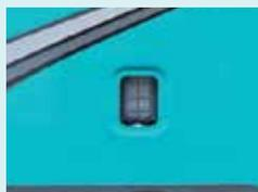
Indicatore del serbatoio dell'olio idraulico
