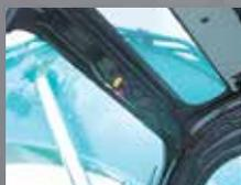
Le pare-brise s'ouvre et se ferme d'une seule pression grâce au dispositif de déverrouillage
