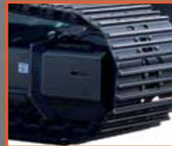
Guide chaîne de roue folle intégré et renforcé
