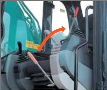
La console du manipulateur gauche se soulève avec le levier de verrouillage de sécurité, pour ajouter 10° à l'angle d'entrée dans la cabine, facilitant ainsi l'entrée et la sortie.
