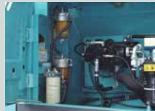
Une cloison pare-feu sépare le compartiment des pompes du moteur
