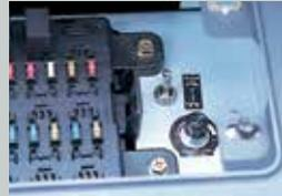
Si un problème inattendu se produisait sur le système de commande mécatronique ITCS, l'utilisation de la machine resterait possible grâce au système d'accélération d'urgence. Les modes d'excavation sont aussi relayés automatiquement vers un système de secours de façon à permettre l'excavation temporairement, le temps qu'un technicien puisse intervenir pour réparer le système principal.
