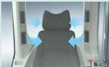
L'ampio climatizzatore è dotato di diffusori posti sui montanti posteriori per diffondere l'aria dal retro e lateralmente a sinistra e a destra del sedile dell'operatore. I diffusori possono essere regolati per emettere un flusso diretto di aria fredda o calda sull'operatore, garantendo un ambiente di lavoro più confortevole.
