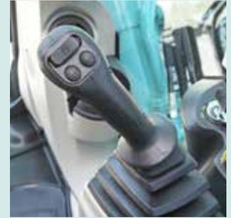
L'utilizzo della leva di azionamento richiede il 25%\* in meno di forza, con una conseguente riduzione della fatica durante le lunghe ore di lavoro o l'uso ininterrotto.
