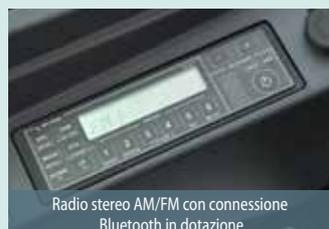
Radio stereo AM/FM con connessione Bluetooth in dotazione
