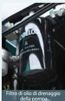
Filtro di olio di drenaggio della pompa
