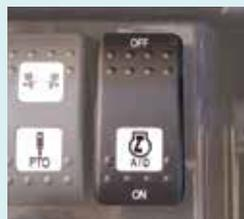
Se le leve di comando sono lasciate in posizione neutra per più di 4 secondi, il regime del motore scenderà automaticamente al minimo per ridurre rumorosità, emissioni e consumo di carburante.
