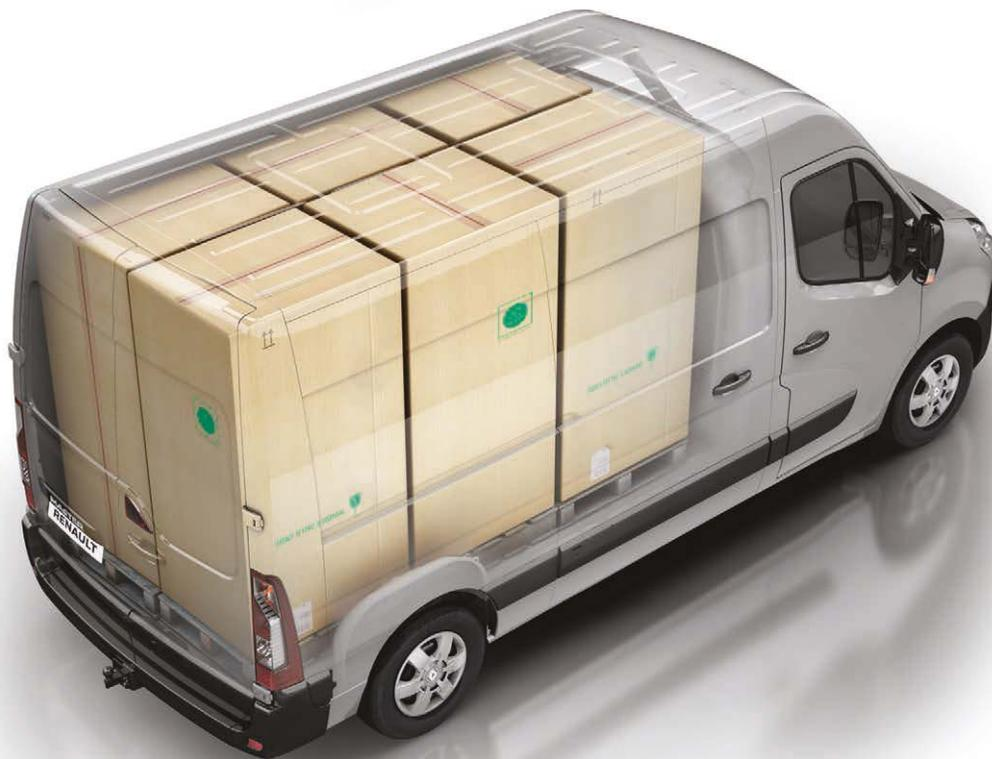
L2H2 a trazione anteriore con ruote semplici (18,8 m<sup>3</sup>).
