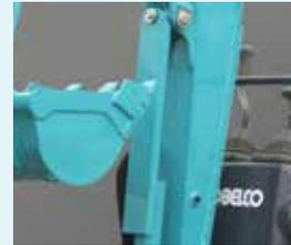
Copertura di protezione del cilindro del braccio di sollevamento
