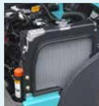
Radiatore in alluminio resistente alla corrosione.
