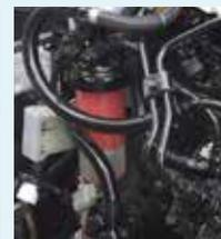
Filtro del carburante con spurgo facilitato dell'acqua.
